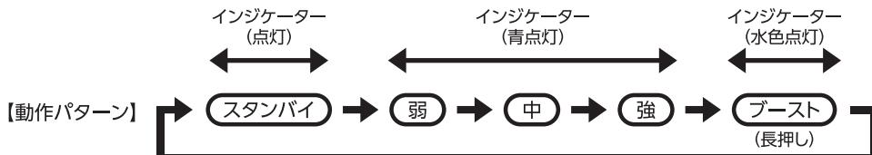
④ブーストは、風力設定をブースト『水色点灯』にした状態でスイッチを長押ししてください。
