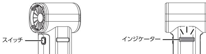
③スタンバイ状態で本体前面のスイッチを単押しすると、下図のパターンで風力が切り替わります。
