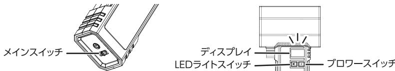
③本体側面のパワースイッチ [4] を単押しすると、ブロワーがオン状態になり下記のパターンで風力が切り替わります。
