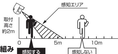
人感センサーは周囲の温度変化を感じて動作する仕組みになっています。
