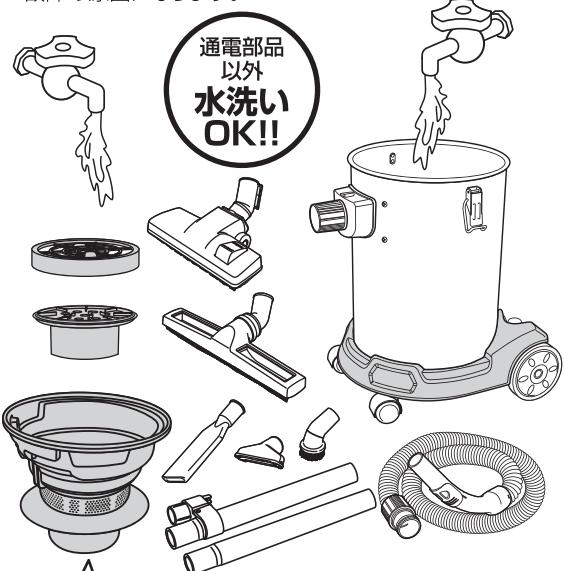
インナータンクの底もはずして洗浄可能。
