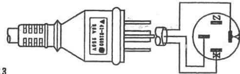
● 直接開閉器に接続する場合の入力ケーブルの接続方法
