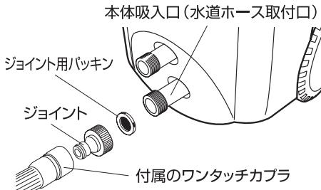
●本体の吸入口にジョイント用パッキンをセットして付属ジョイントを取り付けた後、お手持ちのホースを図の様に取付けて下さい。
