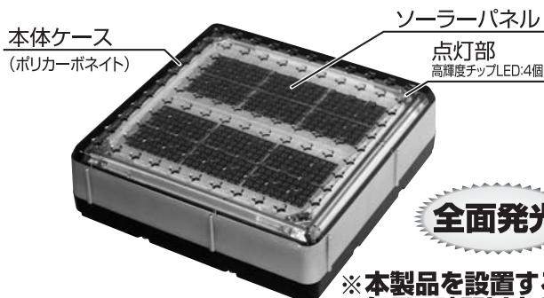
優しい光で飾る、屋外用ソーラータイルは中央に設置している2つのソーラーパネルの4隅に配置したLEDチップによって構成されています。ソーラータイルは太陽エネルギーを受け本体内の**特殊キャパシタ**に充電します。日没後パネル内のセンサーが働きLEDを優しく輝かせ、夜明けになれば自動で消灯します。(パネルはパネル全体で感知する為、多少パネル
