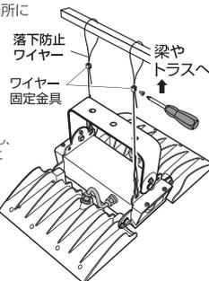
※取付けの際は、本製品の大きさ・質量を十分考慮し、強度を確保できる場所に取付けてください。
