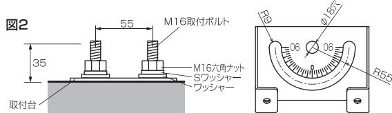
平面取付台は建造物の取付面に図2の取付穴間隔(55mm)でM16取付ボルトを2本設置し、取付台の穴に挿入して2本の取付ボルトそれぞれにワッシャー、Sワッシャー、M16六角ナットをいれ、確実に締付けてください。
