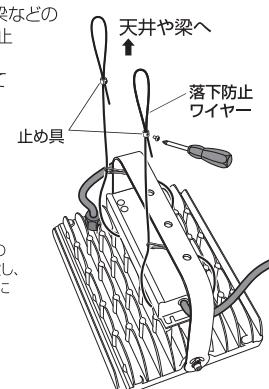
※取付けの際は、本製品の大きさ・質量を十分考慮し、強度を確保できる場所に取付けてください。
