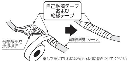
各結線部を自己融着テープおよび絶縁テープなどで絶縁処理をし、電線被覆(シース)も含めて
