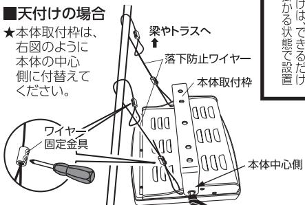
上図のように落下防止ワイヤーをとおし建造物や架台などに確実に取付け、安全措置を施してください。
