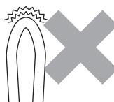
※直角曲げなど、最小曲げ半径以下に曲げないでください。
