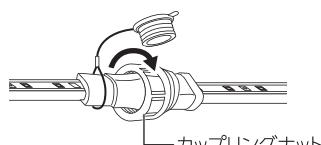
3. 最後尾のコネクター用キャップの切欠きを合わせて閉めて、
