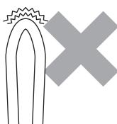
※直角曲げなど、最小曲げ半径以下に曲げないでください。
