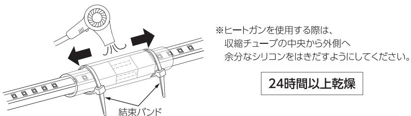
**補修後の注意** 補修箇所は、抜けやすくなっています。強く引っ張るなどしないでください。
