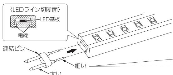
※連結ピンを挿し込む際、電線に真っすぐ挿し込んでください。
