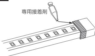
**3** エンドキャップのフちに、透明シリコン適量を塗布し、エンドキャップを覆うように収縮チューブをかぶせてください。
