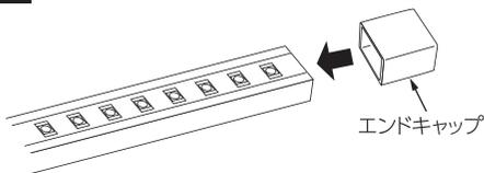
**2** エンドキャップの内側に、付属の専用接着剤を隙間なく流し込むように塗布してください。
