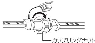
3. 最後尾のコネクター用キャップの切欠きを合わせて閉めて、カップリングナットで確実に締め付けてください。
