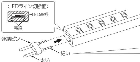
※連結ピンを押し込む際、電線に真っすぐ押し込んでください。
