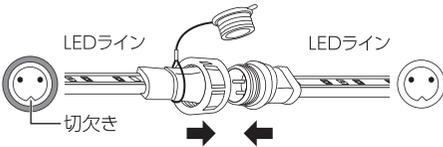
2. カップリングナットを確実に締め付けてください。
