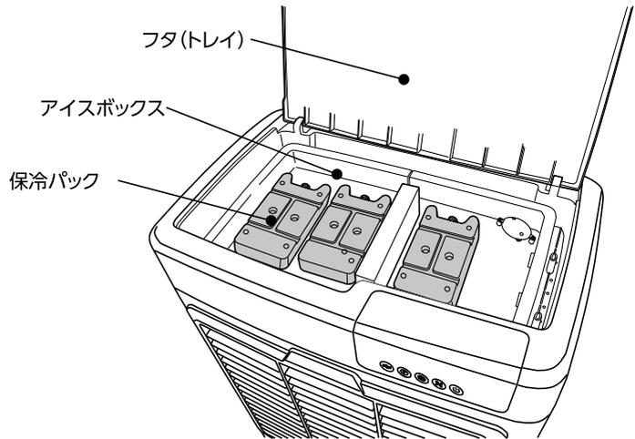
※アイスボックスはポンプで汲み上げられた水を保冷パックで冷却し循環させるため
