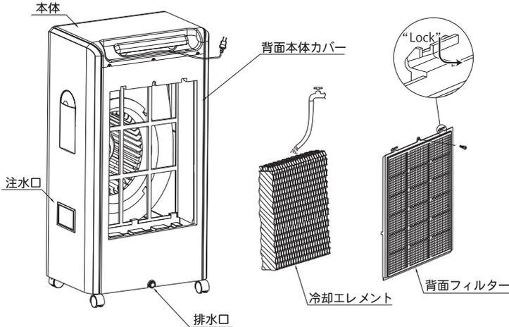
新鮮で清潔な空気を送風するために、こまめに汚れた水を入替え、定期的に背面フィルターと冷却エレメントを清掃してください。
