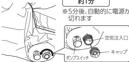
4. 空気が入って張りが出たら、空気注入口のキャップを閉めます。再度ポンプスイッチを押して、電源を切ってください。
