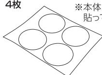
※本体が破損したときに貼って、補修できます。
