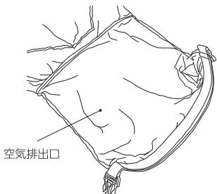
2. 空気排出口を5回以上巻き、左右のバックルを差込みます。
