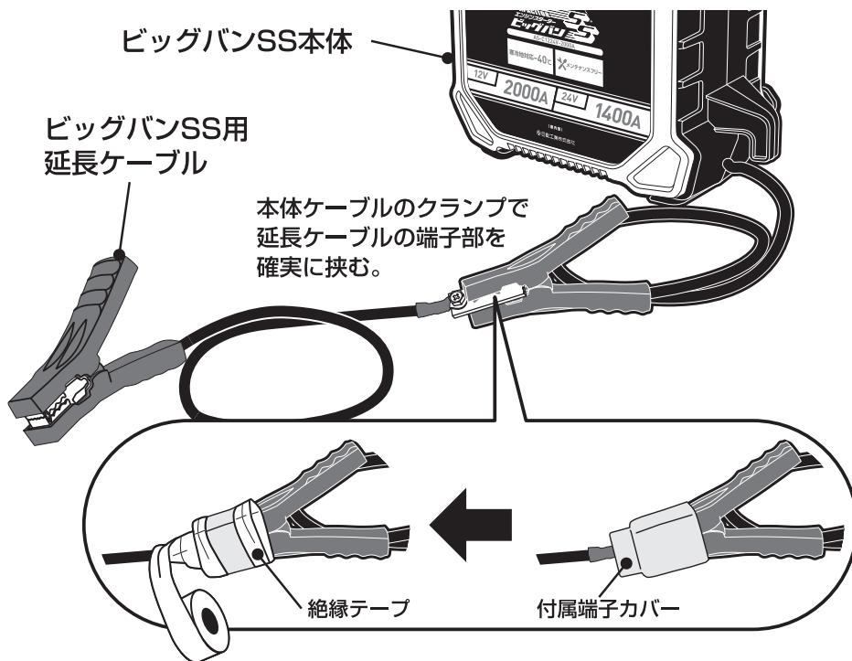
クランプ部が車両などに接触しないよう端子カバーや絶縁テープを使用し
