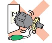
プラグが確実に差込まれず抜けた状態での使用。</p>                                  | <p>接触不良により、発熱し火災などの原因になります。</p>                                                                                                             | <p>
