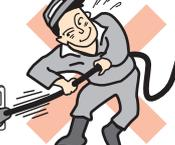
プラグを抜く際、電線を引張って抜く。</p>                                    | <p>プラグ変形および電線破損により、火災・感電の原因になります。</p>                                                                                                       | <p>
