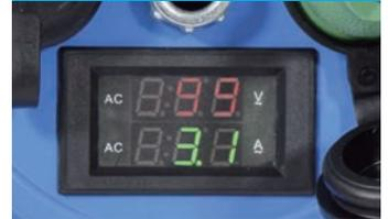
電圧：99V (電圧降下している)
