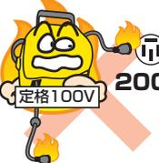
定格電圧と異なる電圧の使用。<br/>(悪い例) 定格100Vで200V電源に使用。</p>              | <p>本製品および接続機器の故障、火災などの原因になります。</p>                                                                                                          | <p>
